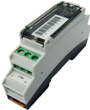
Der Buskoppler dient als Verteilerstation des CAN-Bus-Systems um unterschiedliche physikalische Gruppen miteinander zu verbinden. Die beiden physikalischen Gruppen sind galvanisch voneinander getrennt.
