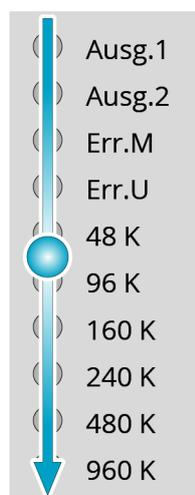
Das Gerät hat sich beim Anschließen an die Versorgungsspannung selbsttätig eingeschaltet. Merkmal: Alle LEDs leuchten durchlaufend blau auf. Die Einschaltphase dauert einige Sekunden.
