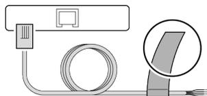
Bringen Sie am Anschlusskabel eine dauerhafte Kabelfahne mit folgendem Warnhinweis an:
