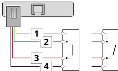
Konfektionieren Sie das Anschlusskabel für den Schaltkontakt des Fremdgeräts.
