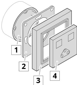
Montieren Sie das Gerät über eine 60 mm UP-Dose:
