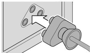
Führen Sie den Stecker des Birntasters an den Magnetsteckkontakt des Rufmoduls heran.
