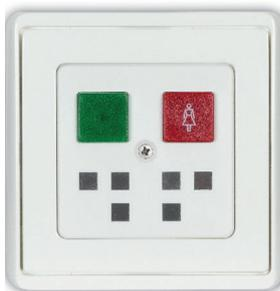
Der Kombitaster, auch Ruf-Absteltaster genannt, verfügt über zwei beleuchtete Tasten. Mit der roten Taste kann ein Bewohner einen Ruf auslösen. Die Rufauslösung wird mit einem Beruhigungslicht und einem akustischen Signal bestätigt. Beim Betreten des Zimmers meldet sich das Pflegepersonal durch Betätigen der grünen Taste anwesend und stellt die Rufe des Zimmers ab. Gleichzeitig wird die Rufnachsendung aus anderen Zimmern aktiviert.
