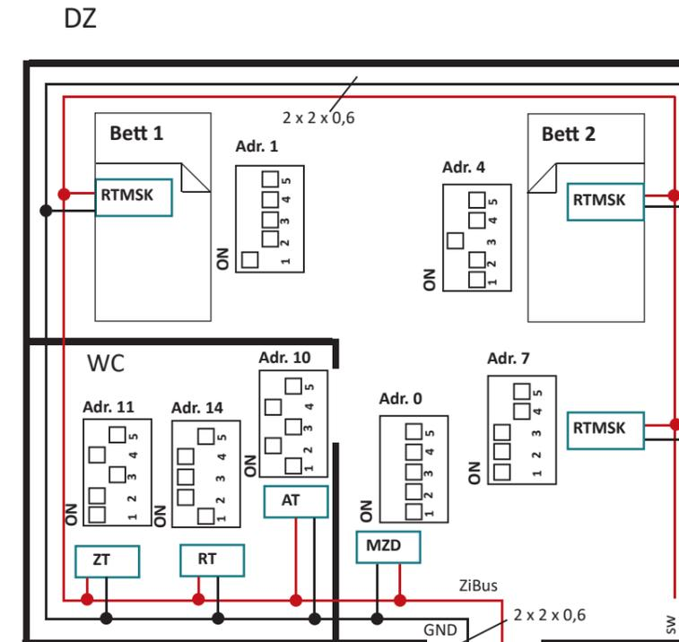
Die Anzahl der Module an einem Strang ist abhängig von der Leitungslänge (Spannungsabfall). In der Regel 10-15 Zimmer an einem Strang.
