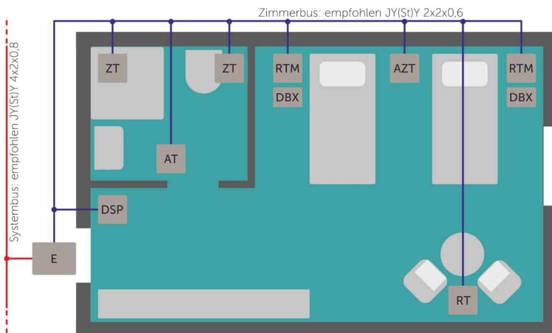
E – Zimmerelektronik mit Zimmersignalleuchte, ZAT- Zug-/Abstelltaster, RAM - Ruf-/Abstelltaster mit MSK Magnetsteckkontakt
