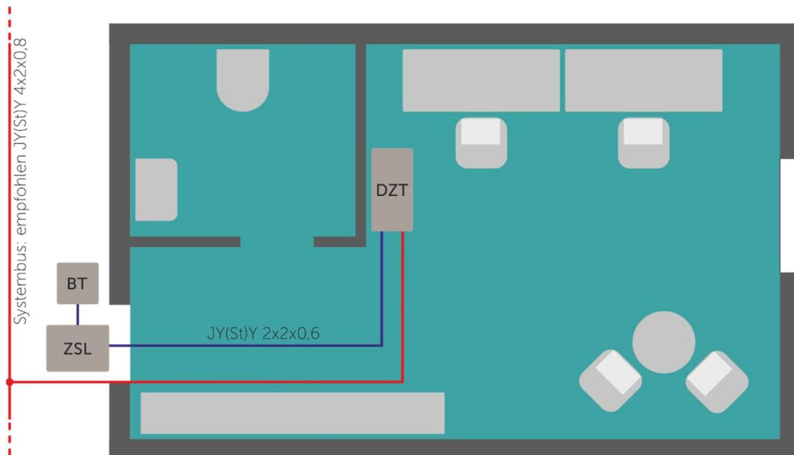
E – Zimmerelektronik mit Zimmersignalleuchte, RAT – Ruf-/Anwesenheitstaster, AT – Abstelltaster, ZT – Zugtaster, PT – Pneumatikstaster, ZSL – Zimmersignalleuchte, DZT – Dienstzimmerterminal, BT – Besuchertaster
