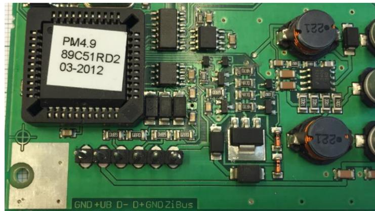
Auf Grund der Schaltfolge von Spannungsversorgung und Daten schwankt die Spannung am Zimmerbus zwischen 8 - 12V.
