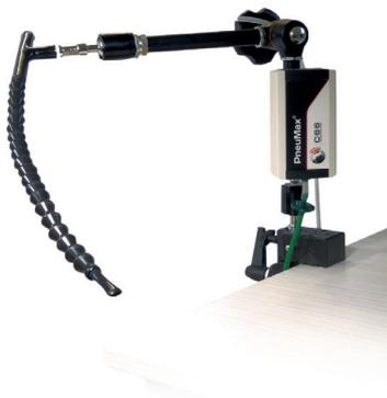
Der Saug-Blas-Kontakt wird über pneumatische Impulse gesteuert. Das Saug-Blas-Kontakt-Set besteht aus einem Mundstückhalter mit Schwanenhals, einem Spangelenk zur Befestigung und einem Saug-Blas-Kontakt zur Rufauslösung.
